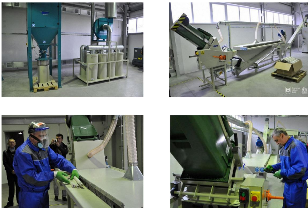
Figura 5.1.2. O equipamento de descontaminação para lâmpadas de mercúrio e outros artigos que contenham vapor de mercúrio [9]
