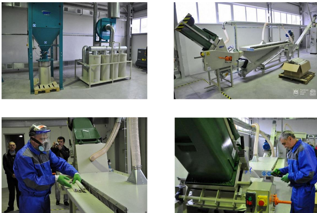
Figura 5.1.2. L'attrezzatura per la decontaminazione di lampade al mercurio e altri oggetti contenenti vapori di mercurio[9]
