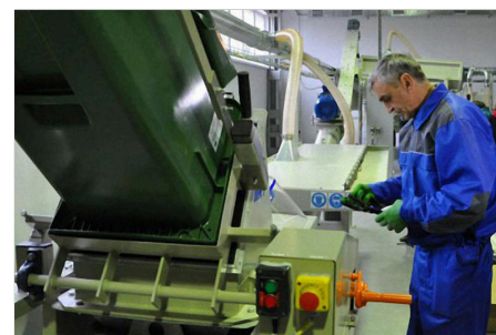
Figura 7. L'attrezzatura per la decontaminazione delle lampade al mercurio e di altri oggetti contenenti vapori di mercurio [7].
