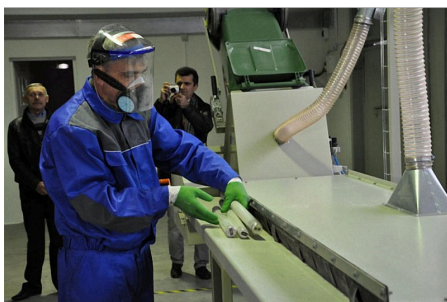
Figura 7. L'attrezzatura per la decontaminazione delle lampade al mercurio e di altri oggetti contenenti vapori di mercurio [7].
