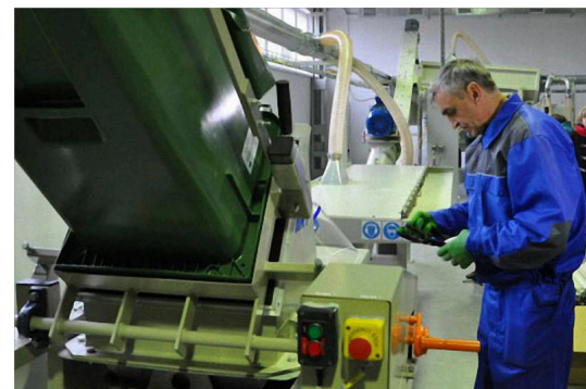
Figura 7. Equipamento de descontaminação para lâmpadas de mercúrio e outros equipamentos que contenham vapor de mercúrio [7].
