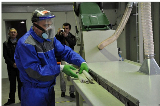
Figura 7. Equipamento de descontaminação para lâmpadas de mercúrio e outros equipamentos que contenham vapor de mercúrio [7].
