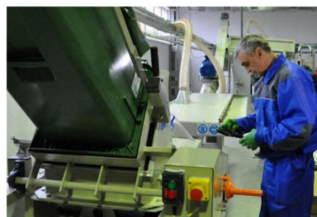
Rysunek 5.1.2. Sprzęt do odkażania lamp rtęciowych i innych elementów zawierających opary rtęci [9]
