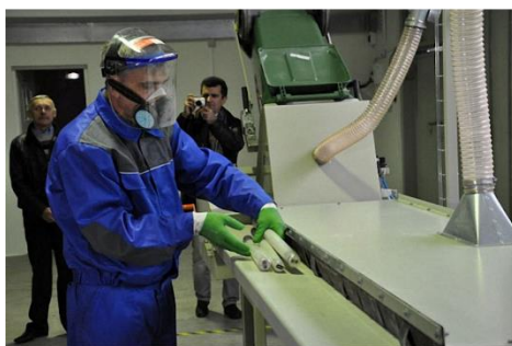
Rysunek 5.1.2. Sprzęt do odkażania lamp rtęciowych i innych elementów zawierających opary rtęci [9]
