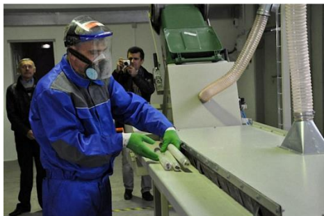
Σχήμα 5.1.2. Ο εξοπλισμός απολύμανσης για λαμπτήρες υδραργύρου και άλλα αντικείμενα που περιέχουν ατμούς υδραργύρου [9]
