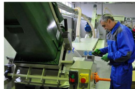
Σχήμα 5.1.2. Ο εξοπλισμός απολύμανσης για λαμπτήρες υδραργύρου και άλλα αντικείμενα που περιέχουν ατμούς υδραργύρου [9]
