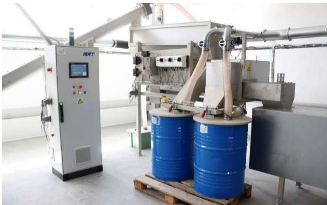
Рисунок 9.3. Обладнання для лінії переробки ртутьвмісних відходів у «Боднарівці» належить шведській компанії «MRTSystemAB»
