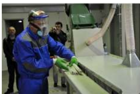
Рисунок 9.4. Обладнання для демеркуризації ртутних ламп та інших предметів, що містять пари ртуті
