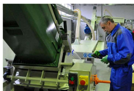
Rysunek 9.4. Sprzęt do odkazania lamp rtęciowych i innych przedmiotów zawierających opary rtęci
