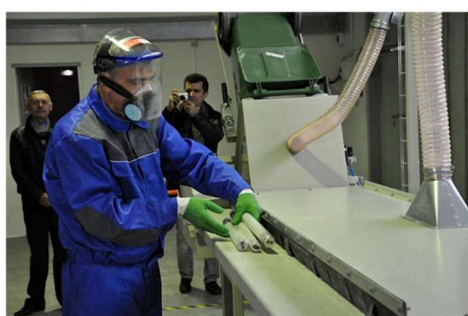
Rysunek 9.4. Sprzęt do odkazania lamp rtęciowych i innych przedmiotów zawierających opary rtęci
